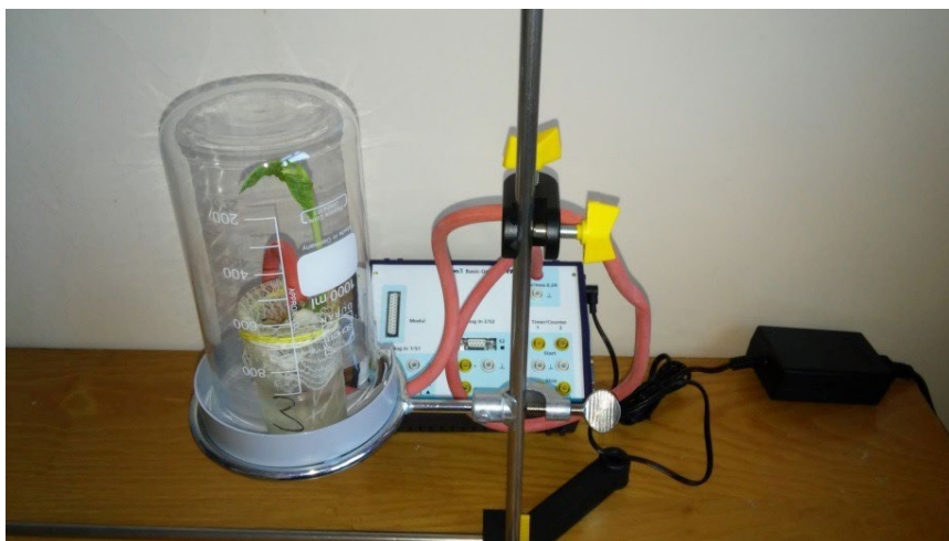
Zdjęcie 1. Przykładowy zestaw pomiarowy ilości wydzielanego tlenu na podstawie pobranego CO 2 przy użyciu urządzenia Basic-Unit (fot. K. Socha)
